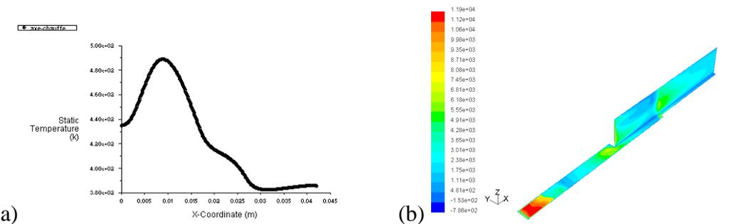
Figure 5 : Profil de température des cellules photovoltaïques (a) et coefficients d'échange thermiques le long du canal (b) pour une vitesse d'entrée de 1 m/s
