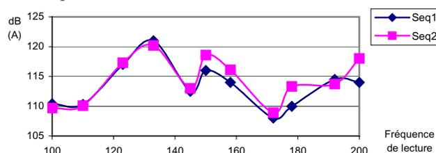
**Figure 4** : Niveau de bruit généré par des séquences EPI en fonction du paramétrage de la fréquence de lecture des points : mise en évidence des modes de résonance et anti-résonances acoustiques du tube de l'aimant.
