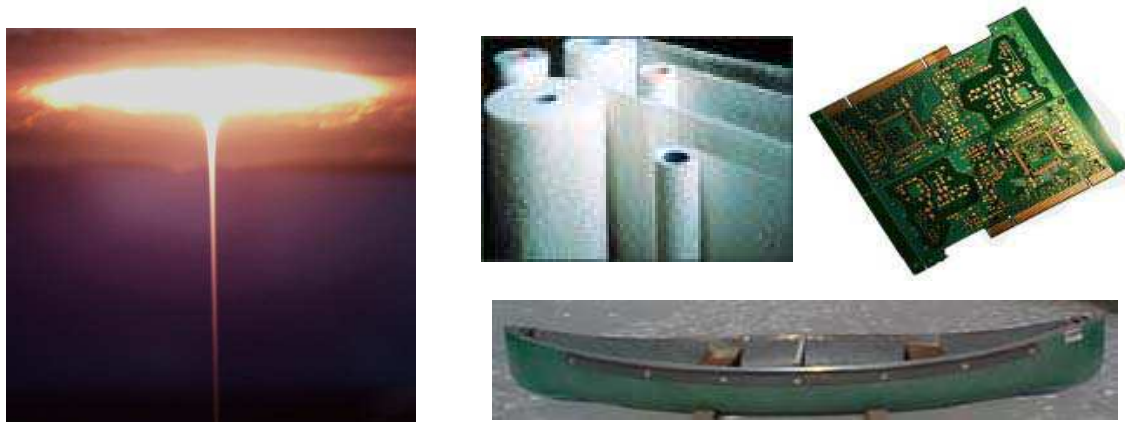
Figure 45 Photographie d'un jet de verre à haute température à l'origine de la formation d'une fibre de verre utilisée pour les applications de renfort : textile, cartes électroniques, objets moulés...
