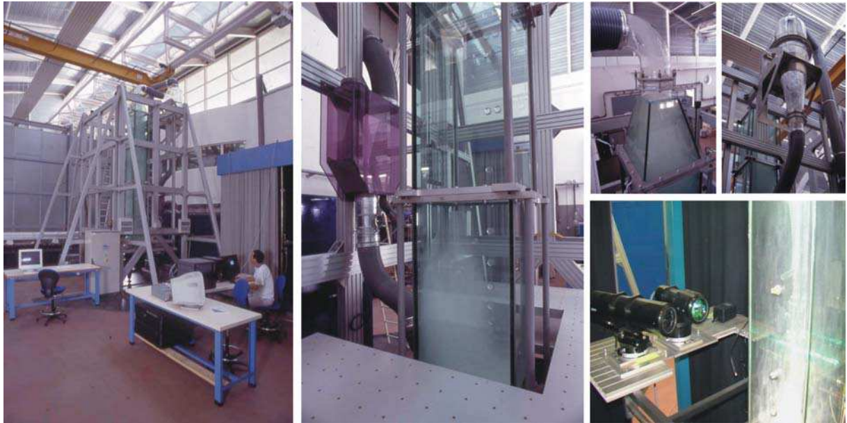
Figure 55 Photographies du pilote LFC atmosphérique de la plate-forme de fluidisation développée à l'USTI.
