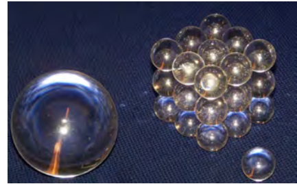
Figure 11 : agrégat 27 sphères comparé à une sphère unitaire et à la sphère diélectrique étudiée précédemment de diamètre 50 mm
