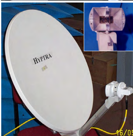
Antenne à réflecteur parabolique large bande : 4 GHz - 8 GHz HYPTRA NE5256
