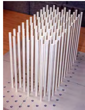
Figure 15 : maquette de modèle de cristal photonique diélectrique bidimensionnel à base hexagonale.
