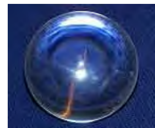
Figure 9 : sphère diélectrique de diamètre 50 mm
