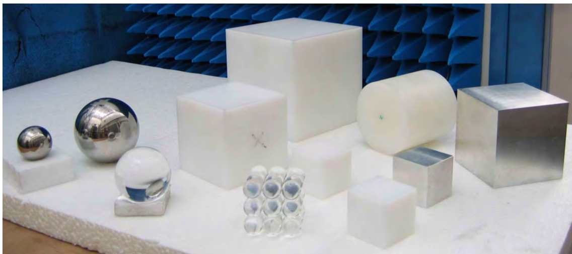
Figure 12 : Cibles 3D métalliques ou diélectriques, simples ou complexes. Le grand cube présente une arête de 100 mm, les moyens de 80 ou 40mm. Les matériaux diélectriques sont soit du PMMA soit du PA6.
