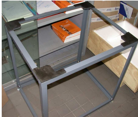
Figure C.4 – Châssis de la cavité.
