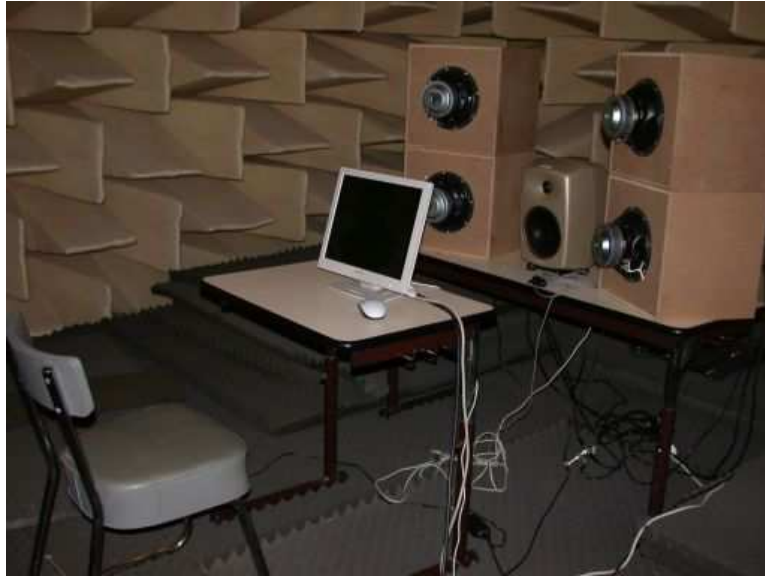
Figure V.4 – Positionnement des haut-parleurs et de l’interface utilisateur pour le test perceptif de dissemblance pour des signaux de TGV enregistrés.
