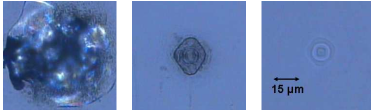
FIG. 6.15 – Images ( 80 \times 80 \mu\text{m}^2 ) de trois sites contaminés par des plots de 5 \mu\text{m} après irradiation à 1064 \text{ nm} : a) 2 tirs à 40 \text{ J/cm}^2 , b) 1 tir à 5 \text{ J/cm}^2 et 100 tirs à 40 \text{ J/cm}^2 , c) 1 tir à 15 \text{ J/cm}^2 et 100 tirs à 40 \text{ J/cm}^2 .
