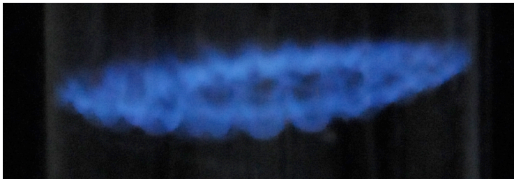
FIG. B.5 – Photo d'une flamme cellulaire, paramétriquement instable.
