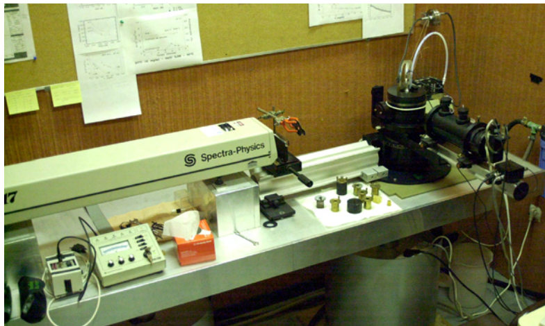
Figure 3.14 : Photographie du montage expérimental de la diffusion de la lumière.
