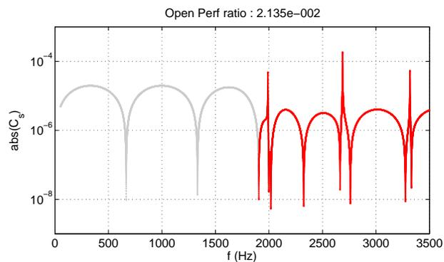
FIGURE 4: Module du terme d'admittance  $C_s$  de la matrice de transfert du système (éq.34). La bande à deux modes propagatifs (en gris foncé ou bien en rouge pour la version couleur) comporte des maximums résonnants qui résultent de l'interférence du mode plan et du mode flûte.
