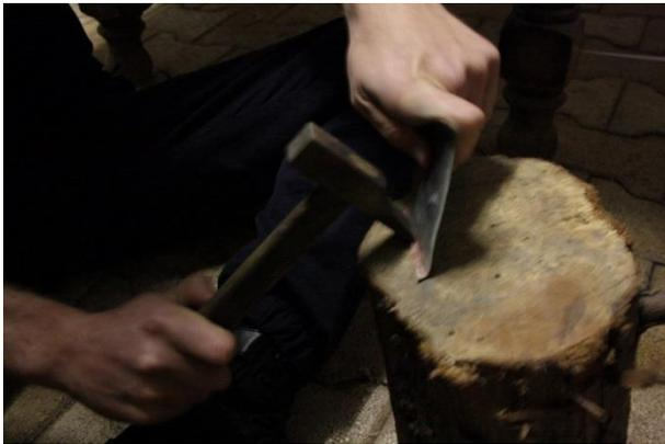
(On replis les bords vers l'intérieur pour éviter les bords tranchants et renforcer la pièce)
