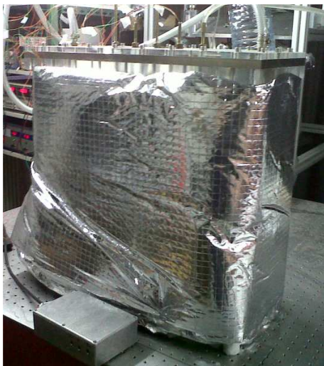
FIG. 3.6 – Cellule et son isolation en Mylar.
