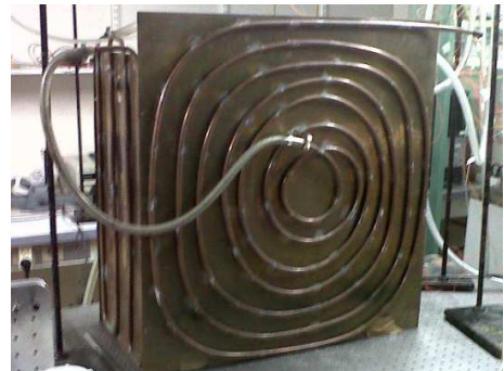
FIG. 3.7 – Cellule et son écran thermique en cuivre
