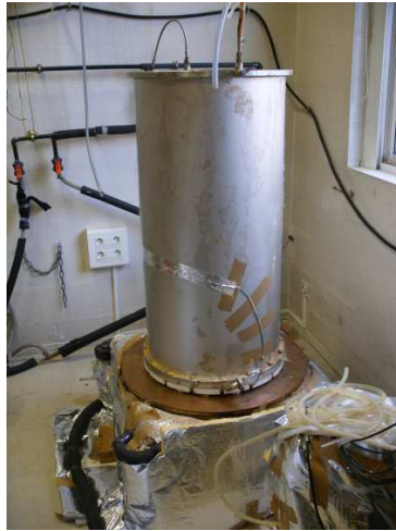
FIG. 2.4 – Paroi latérale de la cellule de convection
