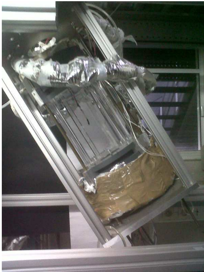
FIG. 8.1 – Photo de la cellule de convection inclinée
