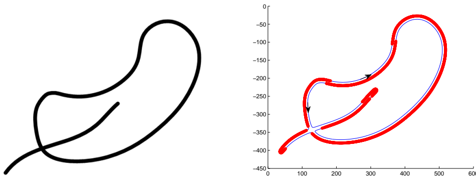
FIG. 6.3: Convention choisie pour le signe de la courbure. A gauche un dessin synthétique, à droite les lignes de niveaux extraites. Les lignes de niveaux négatives sont parcourues dans le sens horaire. Leur courbure est alors négative dans les régions convexes et positive dans les régions concaves. Inversement, les lignes de niveaux de type positif sont parcourues dans le sens anti-horaire pour inverser le signe de la courbure par rapport aux lignes de type négatif. Les portions de lignes de niveaux en bleu correspondent à des courbures positives \kappa(s) \geq 0 avec le sens de parcours de la ligne indiqué par des flèches. Les positions de lignes en rouge correspondent à des courbures négatives \kappa(s) \leq 0 .
