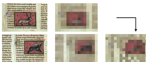
FIG. 3.9: Affectation des pixels par l'EMD entre deux images réelles. L'imagette en bas à droite représente l'affectation des pixels de l'imagette en haut au centre aux positions optimales minimisant l'EMD avec l'imagette en bas au centre. Les pixels de la région rouge requête par exemple ont été assignés au niveau de la région rouge cible. Les marges blanches verticales et horizontales de l'imagette requête ont été assignées au niveau des deux marges verticales de l'imagette cible (voir Figure 3.7c) en bas).
