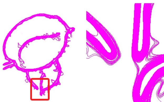
FIG. 5.5: Lignes de niveaux significatives. Cette figure présente l'ensemble des lignes de niveaux significatives du dessin de la Figure 5.4. L'arbre hiérarchique associé contient 717 lignes de niveaux. La carte topographique totale extraite de l'image codée sur 8 bits avec un pas de quantification de 1 contient plus de 26000 lignes de niveaux. A droite, une région du dessin encadrée en rouge est détaillée.
