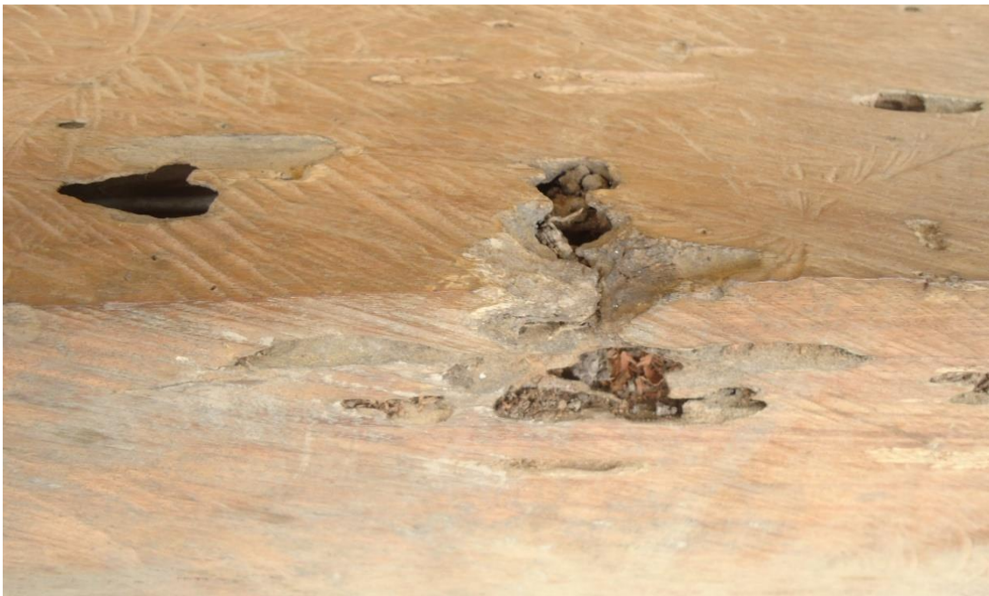
Foto 9. Afectación en las trozas de palosangre por pudrición del tallo, Puerto Leguizamo, Enero 2015, Fundación Cultural del Putumayo, Artesanías de Colombia.
