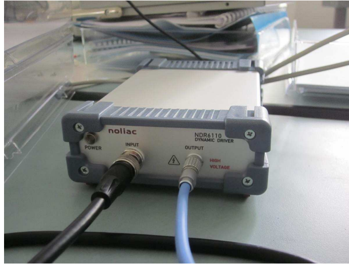
Figure IV.26 : Photographie de l'amplificateur de tension de l'actionneur piézoélectrique
