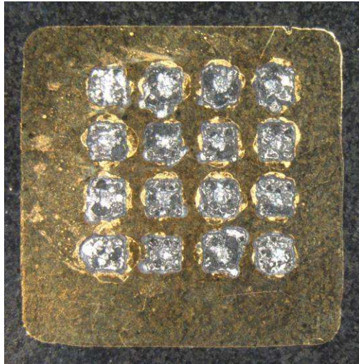
Figure 5-6 Hybridation de 16 plots (de 300 \mu\text{m} de côté) d'In déposés sur une multicouche (16 bicouches) sur substrat W
