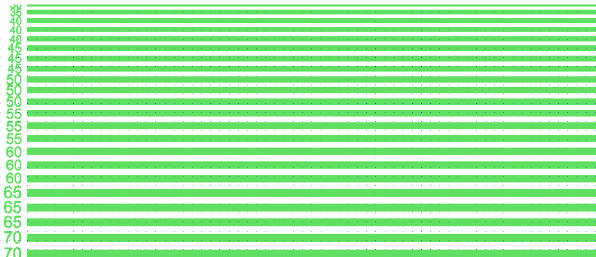
Fig. 2.46 : Partie du masque d'une puce d'aimants zoomé sur l'indication de la largeur du gap
