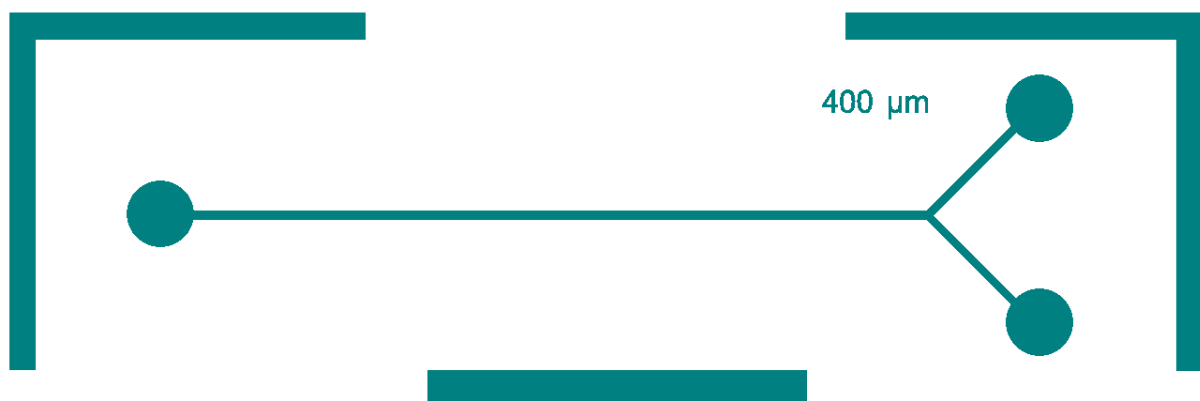
Fig. 3.15 : Masque d'un canal microfluidique de 400\ \mu\text{m} de large adapté à une lame de verre
