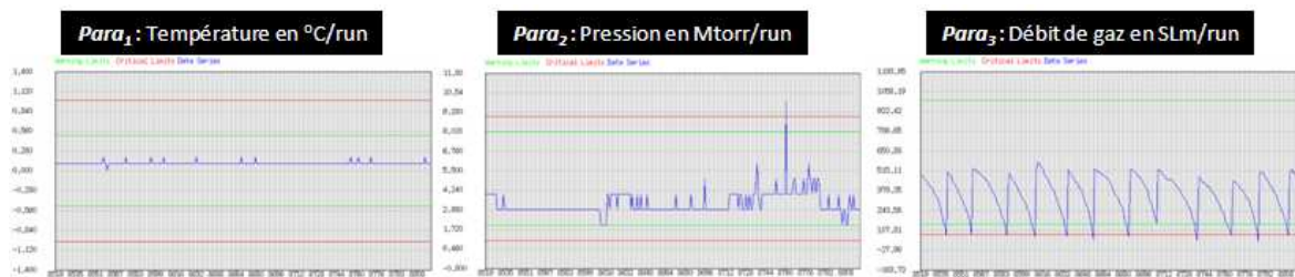
Figure IV.5. Paramètres FDC d'un four LPCVD.
