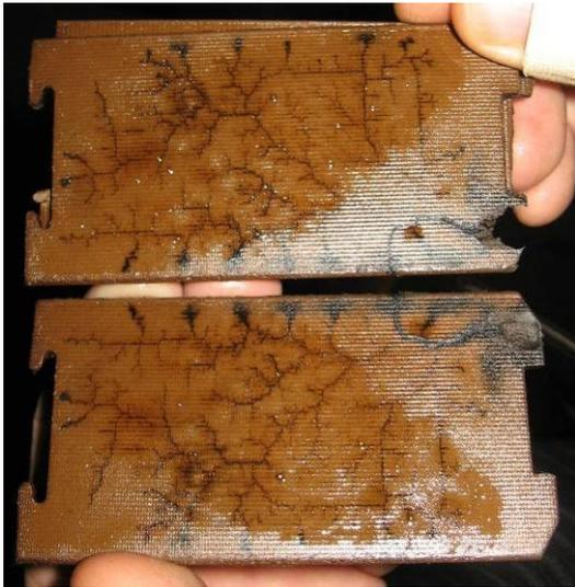
Figure 30 : Décharges partielles sur des cales
