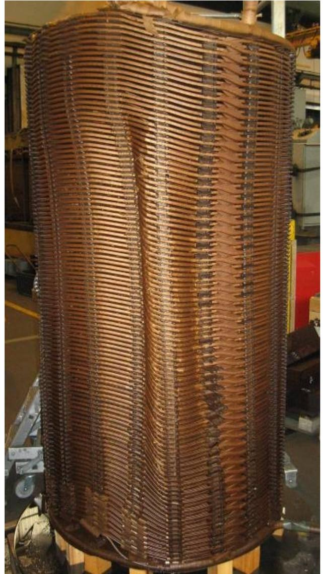
Figure 33 : Déformation mécanique d'un enroulement
