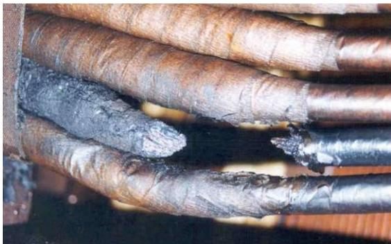
Figure 32 : Coupure suite à la fusion d'un conducteur
