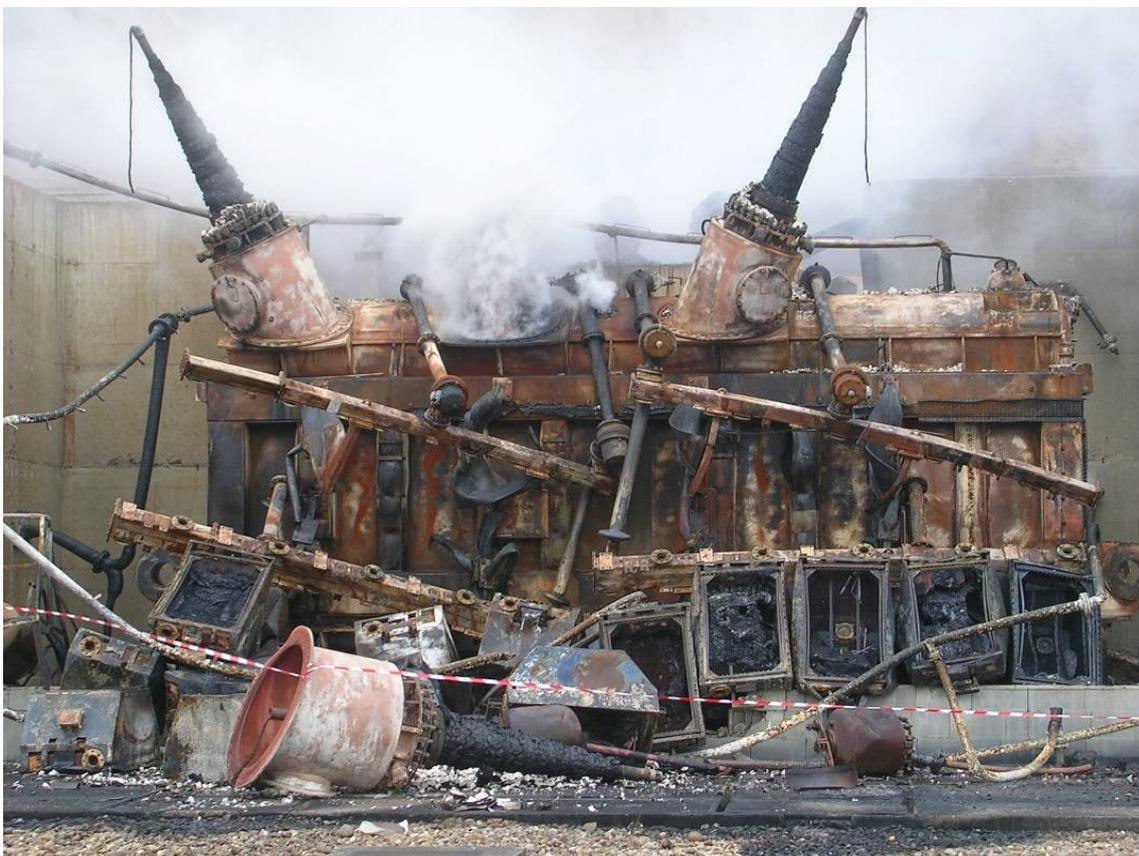
**Figure 18 : Explosion de transformateur**
