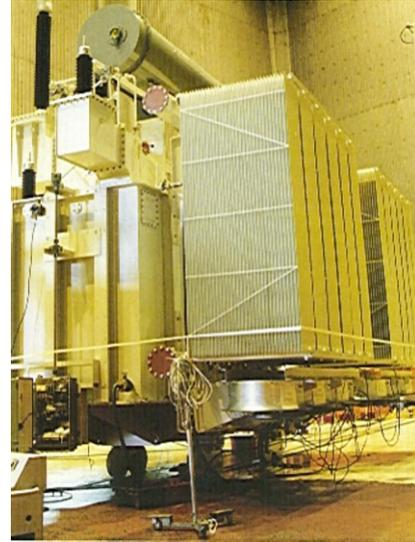
Figure 13 : Radiateurs sur un transformateur
