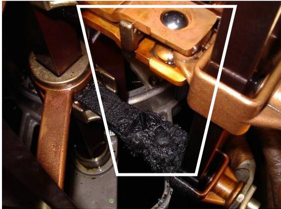
Figure 31 : Point chaud sur le sélecteur d'un régleur en charge
