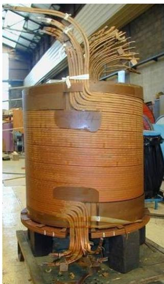
Figure 8 : Enroulement de transformateur
