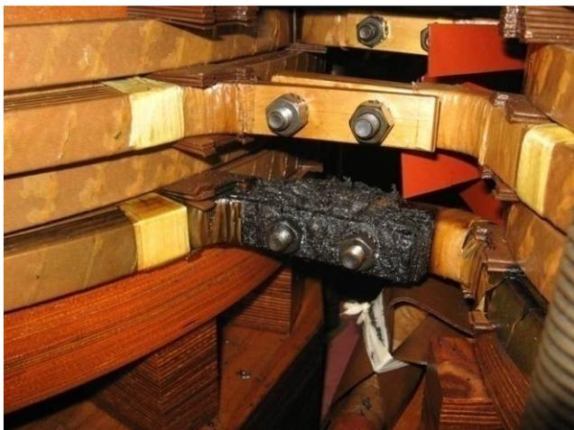
Figure 21 : Point chaud sur connexion boulonnée
