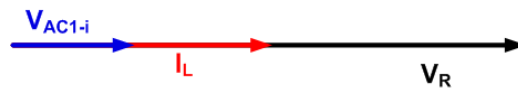
Figure III.6 – Diagramme vectoriel des tensions d’un système de N tuiles PV avec micro-onduleurs avec composante V_L négligée ( \varphi_i=0 )
