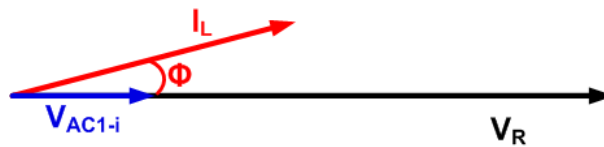
Figure III.11 – Diagramme vectoriel du déphasage du courant I_L et la tension V_R du réseau
