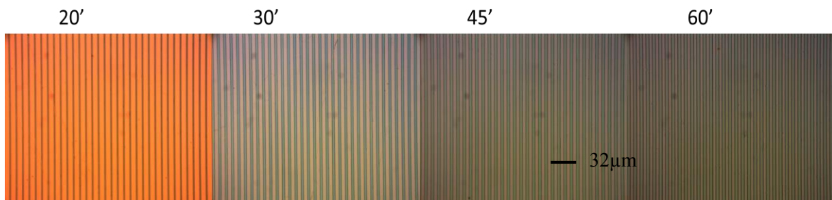
Figure 80 : Photographie optique des échantillons photogravés (1 minute d'insolation) après un prétraitement à 110^\circ\text{C} de durée variable (la barre d'échelle est la même pour tout les échantillons)
