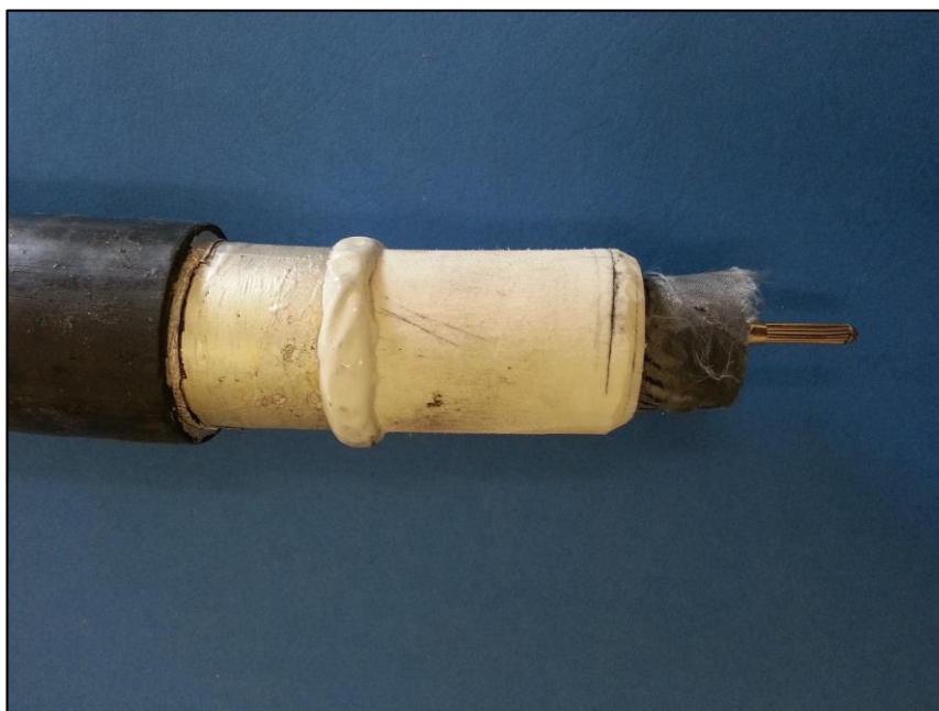
Figure 33 : extrémité d'un câble préparé pour les mesures de décharges partielles
