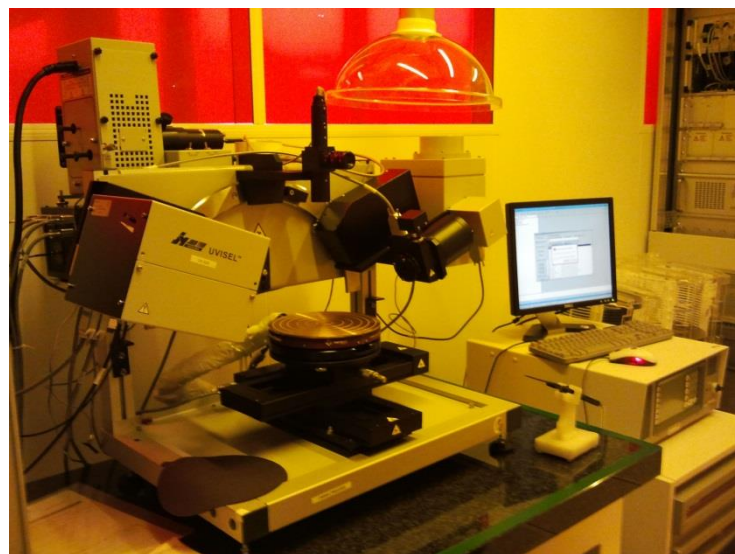
Figure I-23b. Ellipsomètre à modulation de phase Horiba Jobin Yvon en standalone
