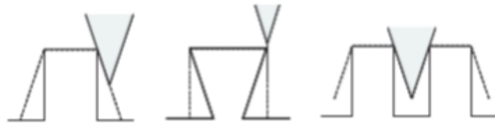
Figure I-7. Déformation du profil par une pointe AFM. On observe que le profil reconstitué par AFM (trait en pointillé) n'est pas le même que le profil réel (trait en continue)
