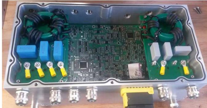
Figure I-20 : Photographie d'un module chargeur de batterie de 20 kW.
