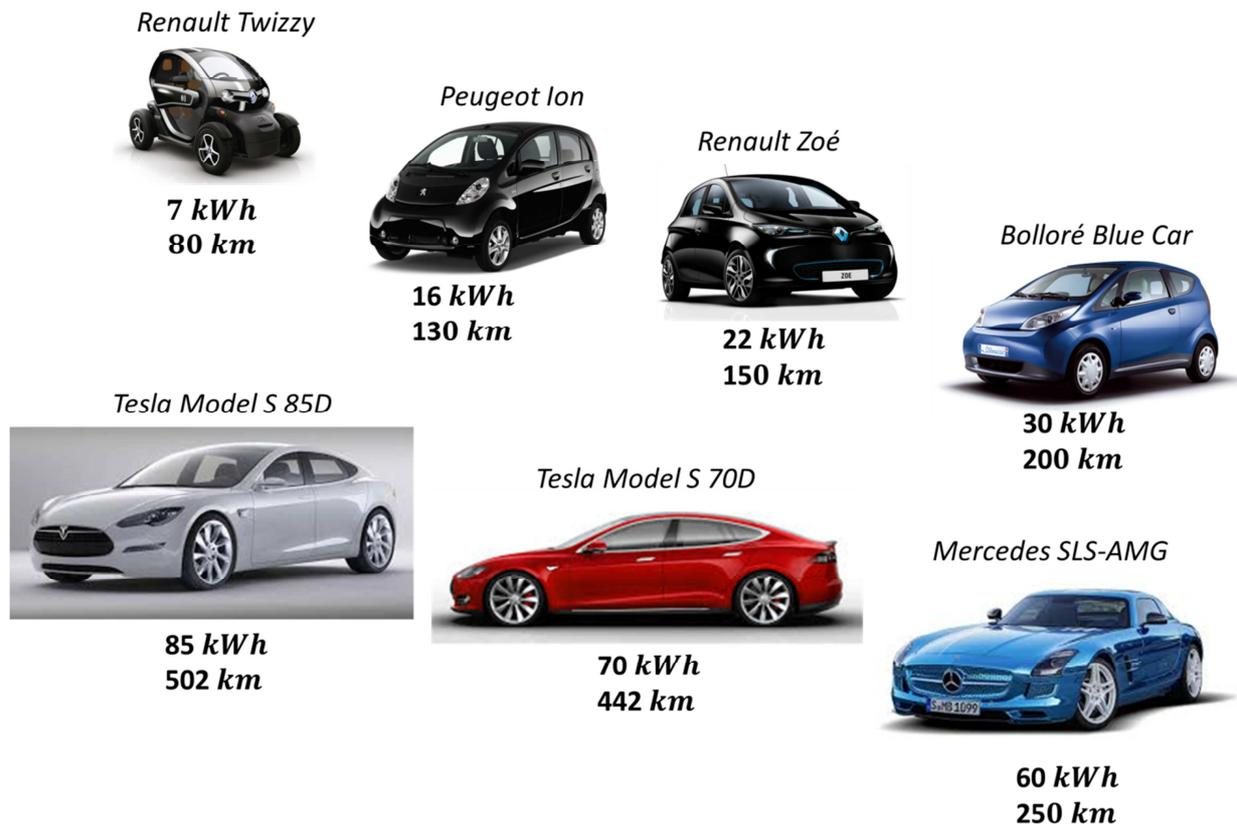
Figure I-2 : Exemple de VE avec l'énergie embarquée dans les batteries et leur autonomie totale.
