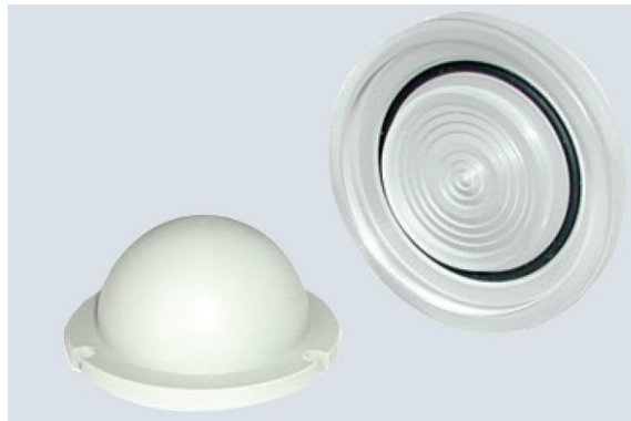
Figure II-3: Porte-échantillon utilisé pour les mesures XRD.
