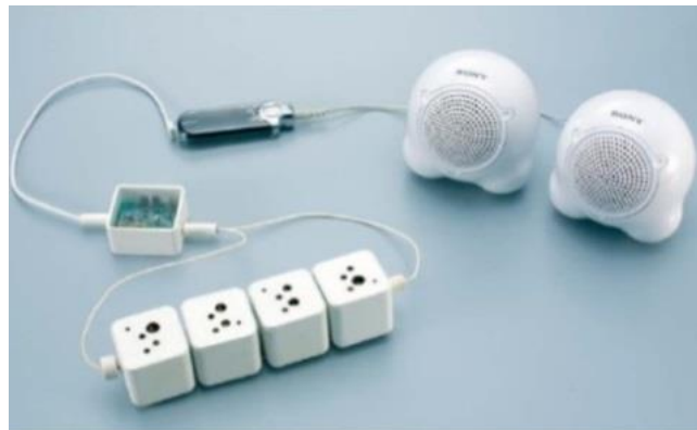
Figure 5 : Un lecteur MP3 Sony alimenté par une biopile à glucose/O 2 [42]
