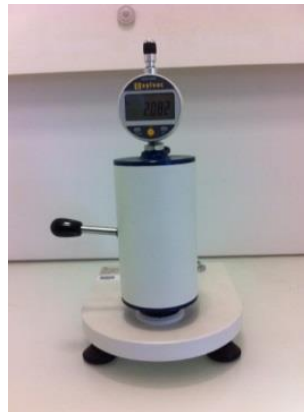
Figure 47 : Micromètre Adamel Lhomargy MI.20
