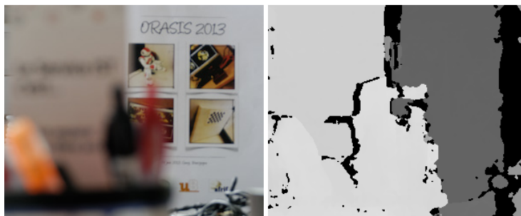
Figure 16. Détail de l'image GLoin2 du jeu "Desk" et sa carte de profondeur calculée correspondante. Le stylo rouge et toute sa zone de flou autour sont étiquetés à la profondeur "Près", alors que les mesures de flou correspondent à des valeurs de "Loin"
