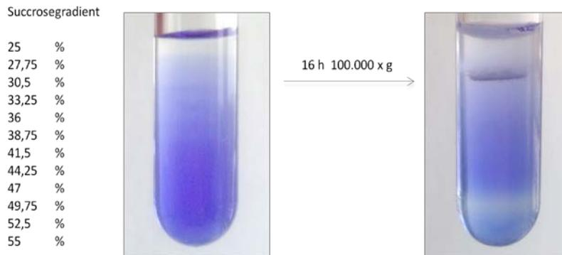
Abb. 4: Darstellung des mit Bromphenolblau eingefärbten Saccharosegradienten vor und nach der Ultrazentrifugation.
