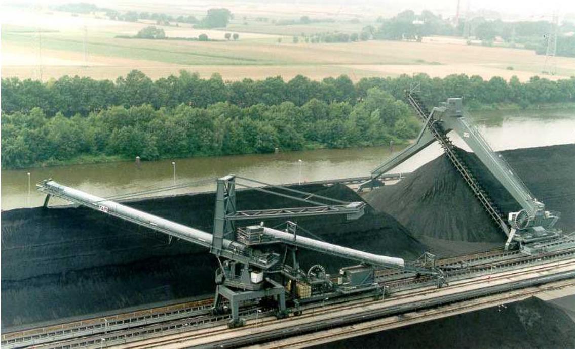
**Bild 1-7:** Lagerplatzgeräte Absetzer (links), Portalkratzer (rechts)
