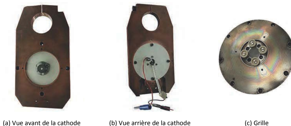
Figure 1.3 – (a) cathode sur son isolant en nitrure de Bore (en blanc) et (b) connectée avec deux fils de tungstène isolés par des céramiques, et (c) grille en molybdène maintenue par des céramiques et des vis en molybdène
