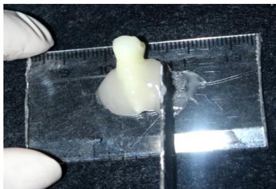
Fig. 6. Fijación de los dientes con resina acrílica.
