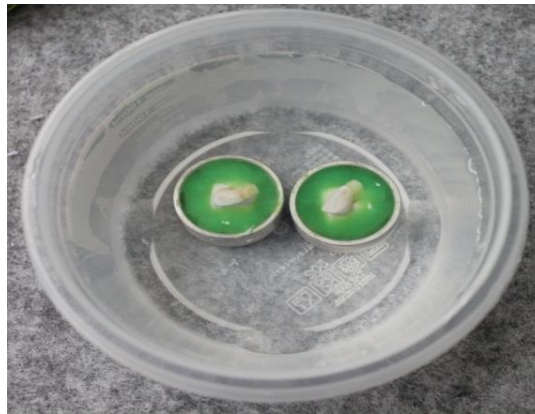
Fig. 18. Colocación en agua desionizada durante la reacción térmica del acrílico.
