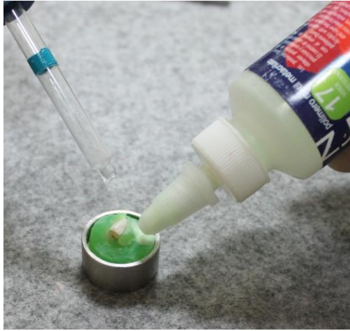
Fig. 17. Sembrado de especímenes con técnica de polvo-líquido.
