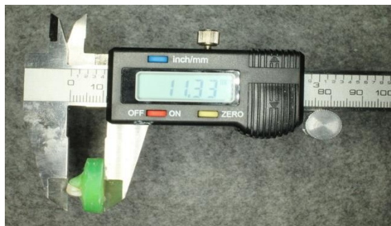
Fig. 22. Especímenes calibrados usando el vernier digital.
