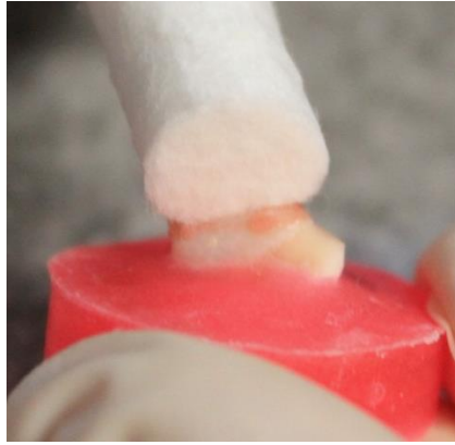
Fig. 32. Limpieza del espécimen con un rollo de algodón y agua.
