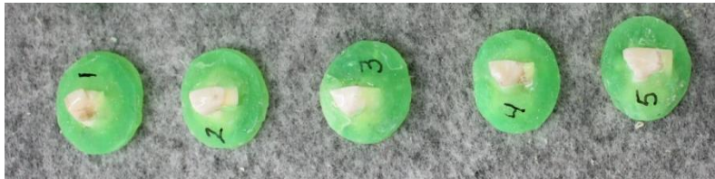
Fig. 21. Obtención de los especímenes después del retiro de los aros metálicos.
