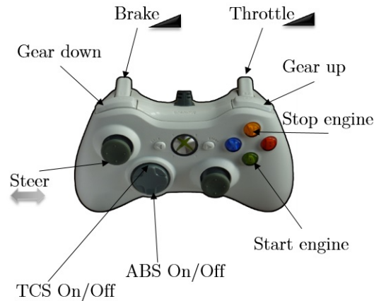
Figure 5.23 Contrôle analogique classique de type "jeu vidéo"
