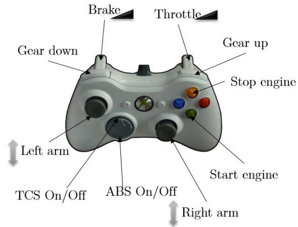
Figure 5.24 Contrôle analogique avancé pour la direction
