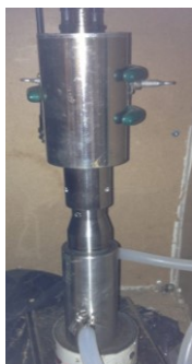
Figure 3.5 : Sonde vissée à la cellule de recirculation
