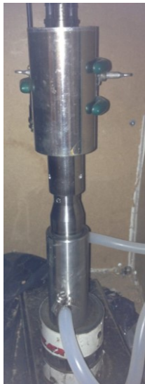
Figure G.3 : Sonde vissée à la cellule de recirculation
