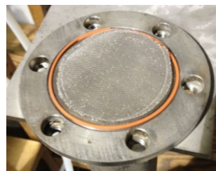
Figure 3.6 : Tamis et joint aux extrémités du corps du réacteur
