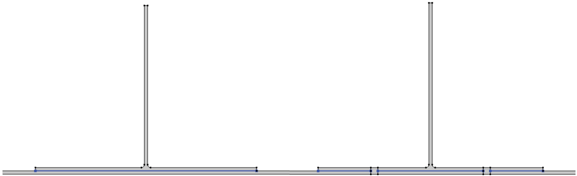
FIGURE 4.12 Modèles éléments finis sans rivet (gauche) et avec rivets (droite).
