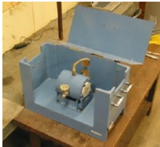
**Figure 2.4: Appareillage pour l'essai de traction par pression de fluide [Uno *et al.*, 2011]**
