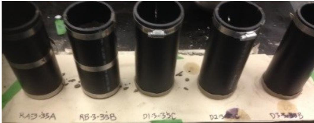
**Figure A.4: Moules en plastique ABS utilisés pour couler les échantillons composites**
