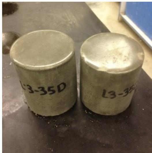
**Figure A.3: Surface lisse obtenue en utilisant le côté lisse du silicone**
