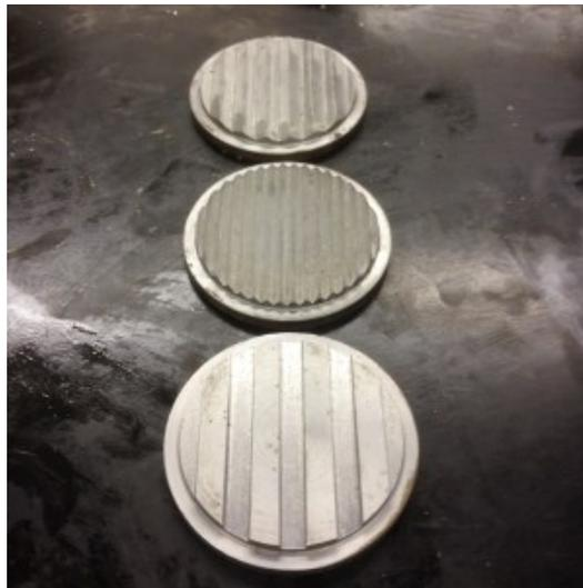
**Figure A.1: Moules d'acier servant à créer trois des cinq géométries d'interfaces différentes**
