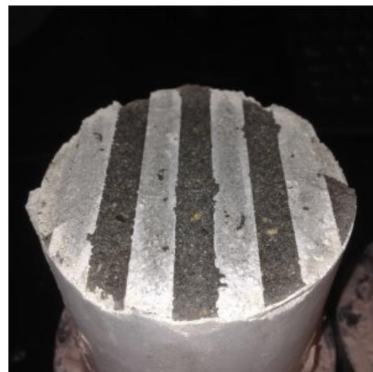
**Figure 4.6: Apparence des interfaces D1, D2 et D3 rompues en traction. La portion en mortier-roche est à gauche et la portion en mortier-béton est à droite.**
