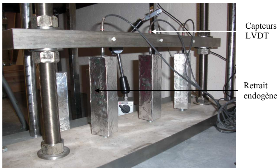
Figure 80. Module de mesure de retrait (échantillons de retrait endogène)
