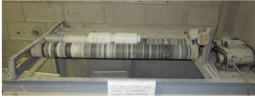
Figure 60. Coulis sur rouleaux rotatifs pour déterminer w_\infty
