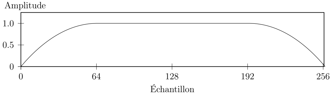
Figure 3.10 Longueur et forme de la fenêtre appliquée sur le signal de synthèse \hat{x}_h
