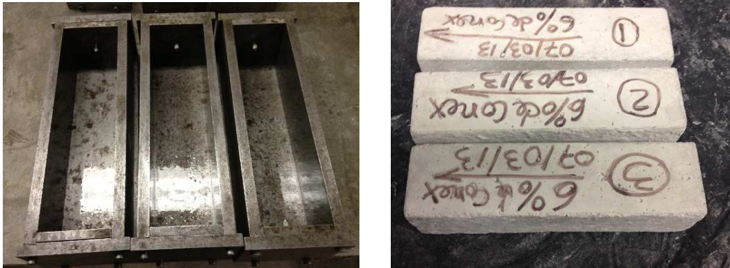
Figure 4.10 - Coffrage et échantillons pour la mesure du retrait
