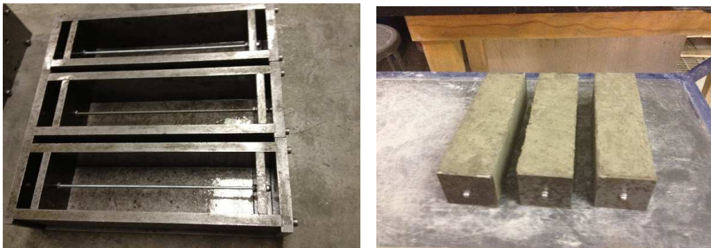
Figure 4.9 - Coffrage et échantillons pour la mesure de l'expansion restreinte
