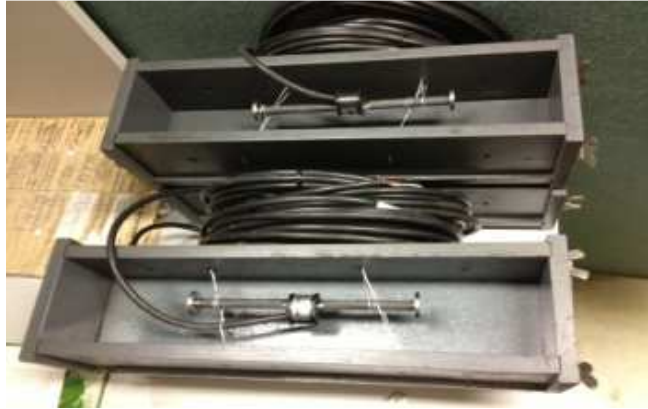
Figure 2.20 - Mise en place d'une jauge de déformation à corde vibrante
