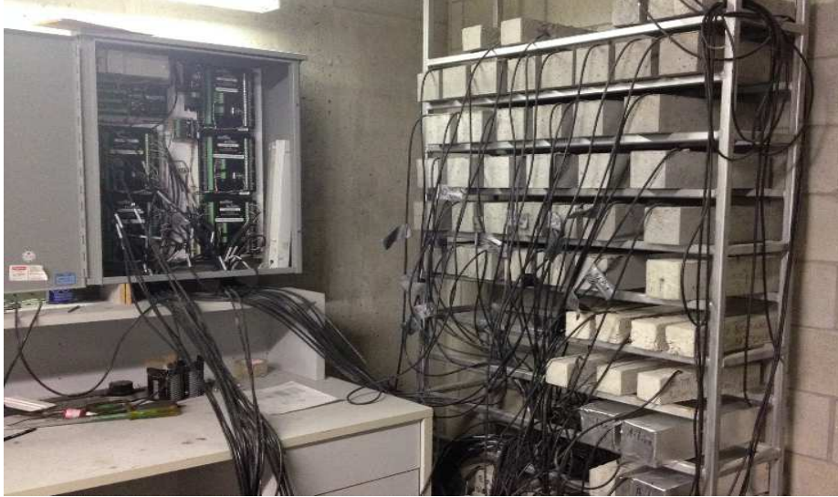
Figure 4.11 - Raccordement des échantillons à la centrale d'acquisition de données pour la mesure de l'expansion libre
