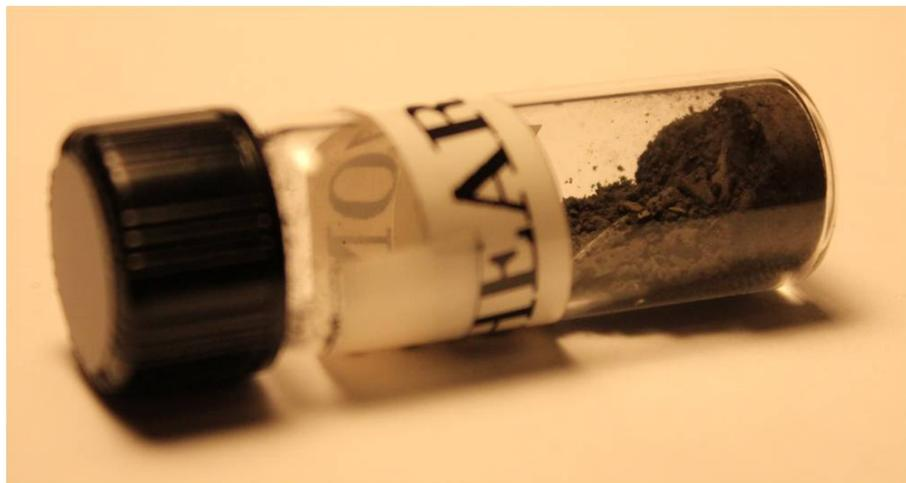
Figure B.3 Échantillon de fluide MR provenant de l'interface de cisaillement du test G7.
