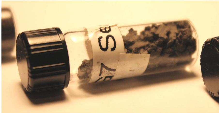
Figure B.4 Échantillon de fluide MR provenant de la zone morte près des joints d'étanchéité du test G7.
