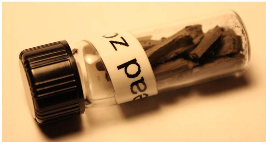
Figure B.5 Échantillon de fluide MR provenant de la zone morte du test G7.
