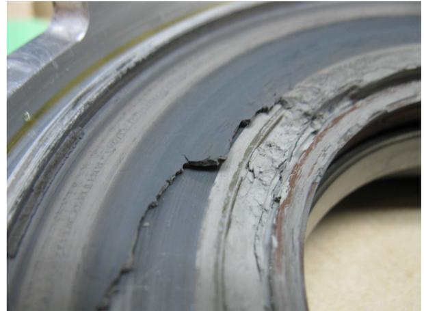
(b) Zoom sur le fluide MR collé sur la partie statique de l'embrayage
