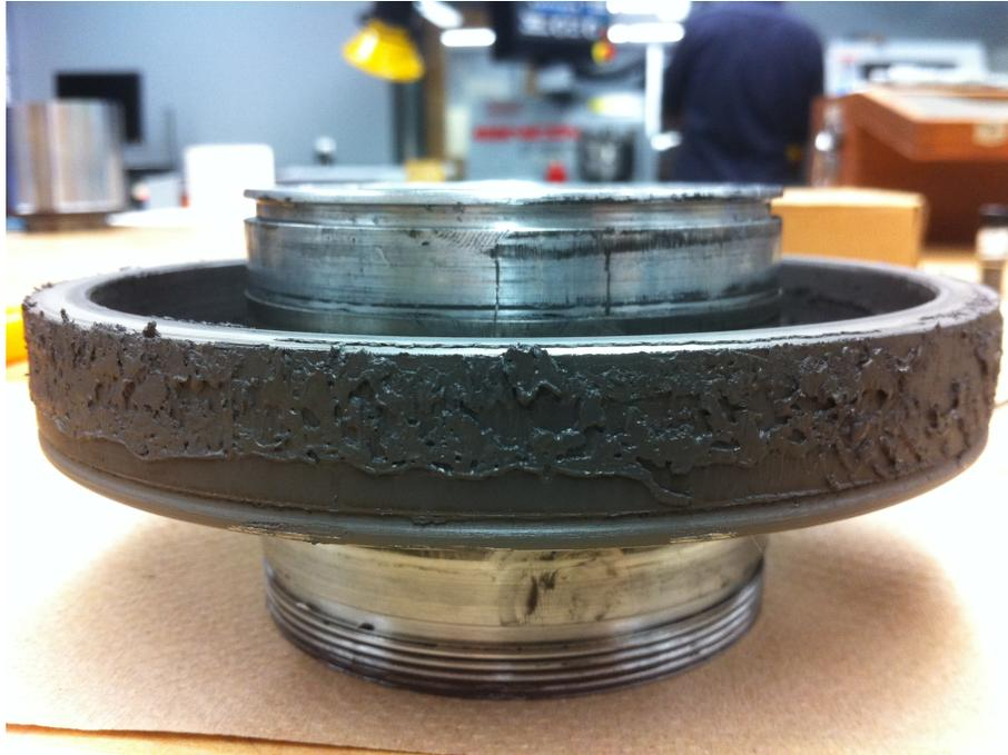
Figure B.2 Photo de l'état du fluide MR situé à l'interface de cisaillement après le test G6
