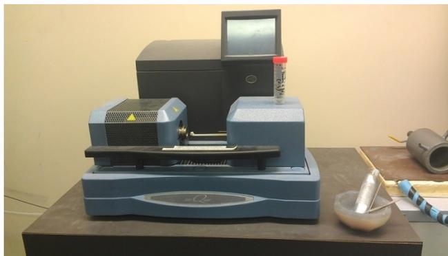
Figure 4.16 Analyseur gravimétrique SDT Q600
