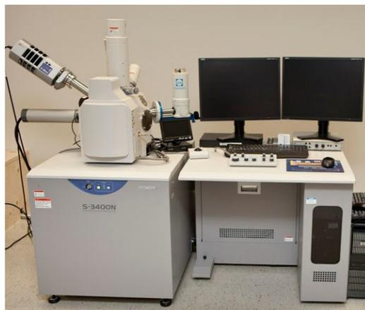
Figure 4.8 Microscope électronique à balayage Hitachi S-3400N
