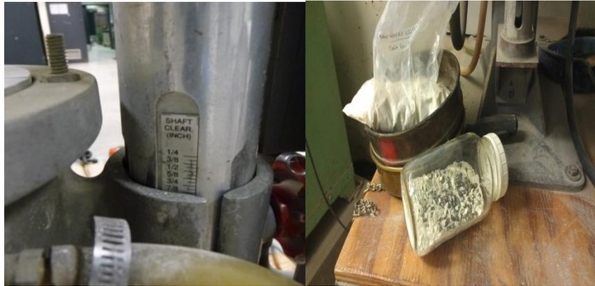
Figure 4.4 Réglage de la hauteur de l'Attriteur (a), mélange des nanopoudres de verre avec les billes (b)
