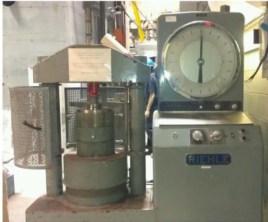
Figure 4.17 Appareil d'essai de résistance à la compression de cube de mortier
