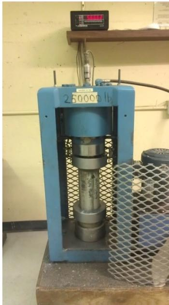
Figure 4.22 Appareillage d'essai de résistance à la compression des bétons
