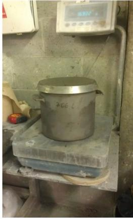
Figure 4.19 Mesure de la masse volumique du béton à l'état frais
