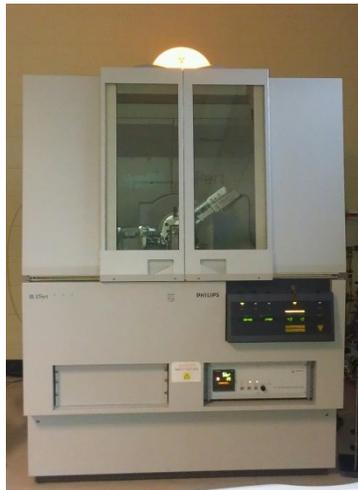
Figure 4.7 Diffractomètre à rayons X
