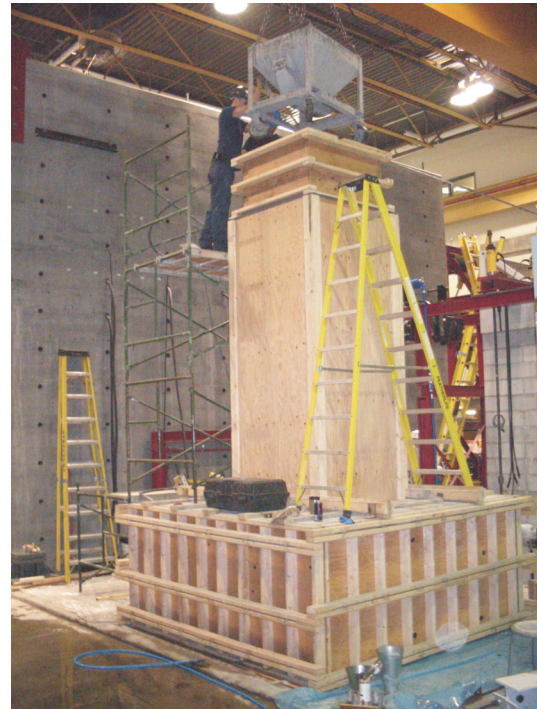
(b) Étape 2 : poteau.
