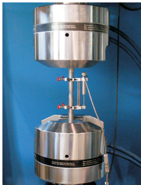
Figure 3.8 – Essais en traction sur les barres en acier.
