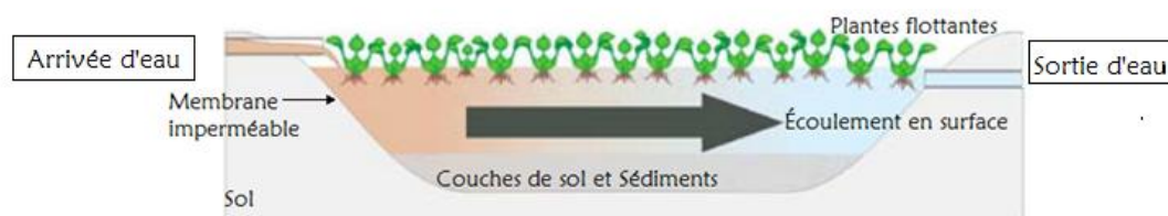
Figure 3.4 : Représentation schématique d'un marais filtrant à écoulement sur la surface avec plantes flottantes (Adaptée de : Gagnon et autres, 2013, p. 3)
