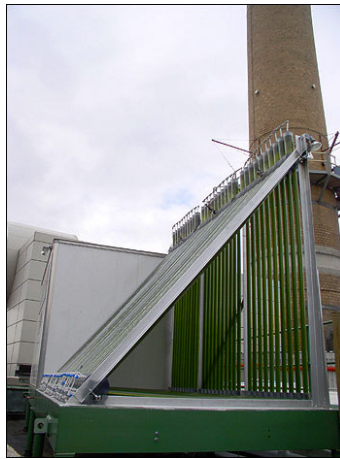
Figure 3.2 Première technologie de Green Fuel. (Les tubes font trois mètres de hauteur) (Cnet, 2009).
