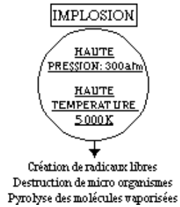
Figure 2.3 : Phénomène d'implosion créé par le principe de cavitation (Sinaptec, 2009).
