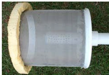
Figure 2.2 : « Microstrainer » rotatif utilisé pour la récolte des microalgues (Oilgae, 2009).
