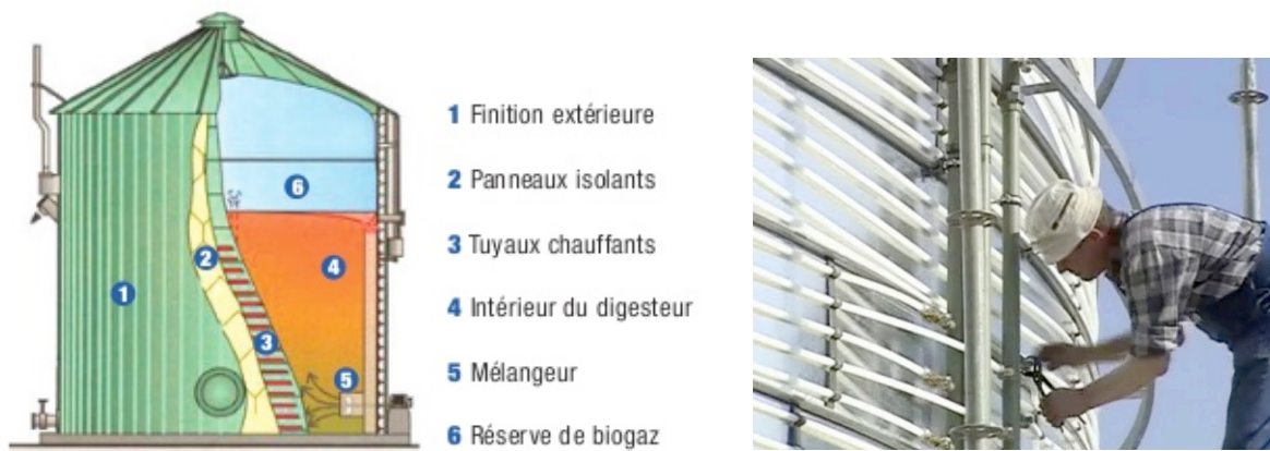
Figure 2.6 Schéma d'un réacteur Lipp et détail des tuyaux chauffants. Tirés de Dominion & Grimm environnement (2007 et s.d.b).
