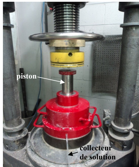
Figure 2.2. Appareil pour extraction de la solution interstitielle des pâtes et des mortiers durcis
