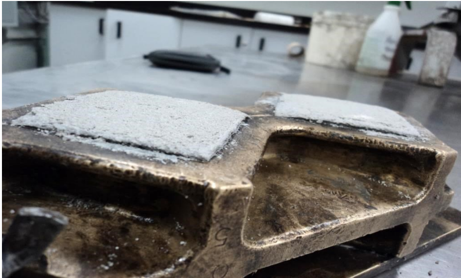
Figure D-1. Gonflement des échantillons de mortier avec 100% des CVK7 et un rapport eau/liant de 1,0 à l'âge de 24h
