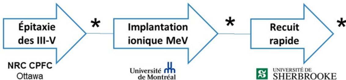
Figure 1.8 Ma question de recherche : « Avec ce procédé, peut-on établir des conditions de fabrication qui produisent des couches d'InGaAsP photoconductrices, résistives et potentiellement ultrarapides ? » Les astérisques (*) correspondent à des étapes de caractérisations optiques, électriques et structurales et de microfabrication.
