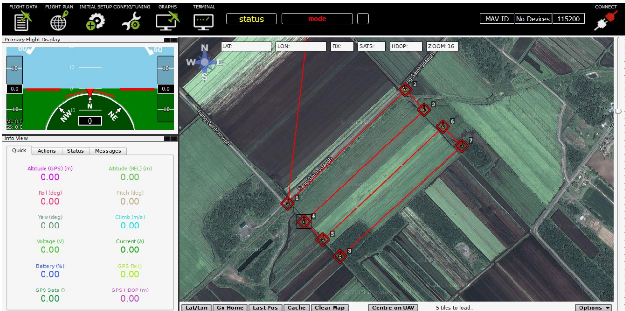
Figure 15 : Définition des points de passage (carrés rouges) du trajet (lignes rouges) d'acquisition d'imagerie de l'ASP pour une parcelle de pomme de terre en Montérégie, à l'aide de l'interface du logiciel associé à l'autopilote ( APM Mission Planner ).
