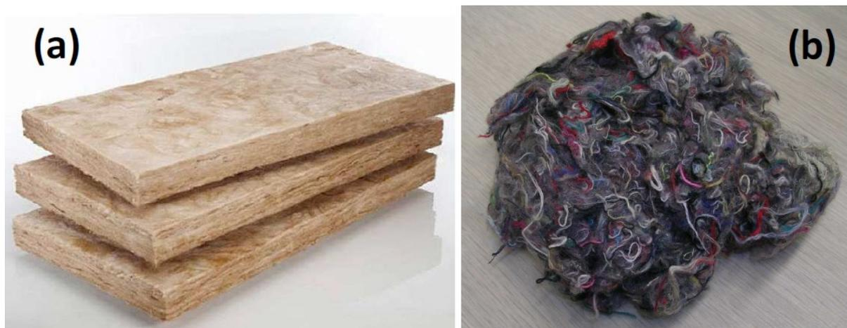
Figure 4.14 : Matériau absorbant utilisé a) laine de verre rigide pour les écrans de référence, b) polyester post-consommation pour les écrans « éco-acoustiques »
