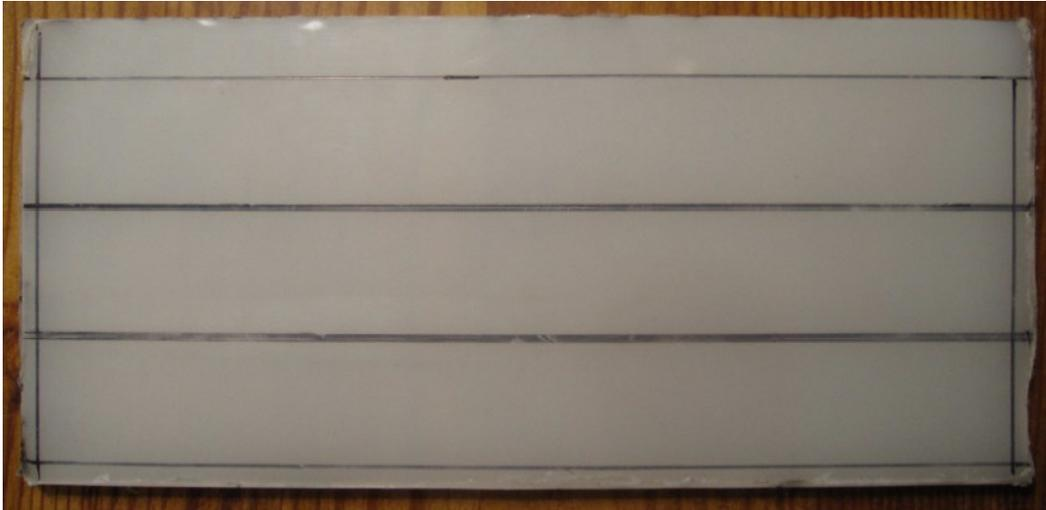
Figure 3.3 : Plaque de LLDPE réalisée pour les essais mécaniques
