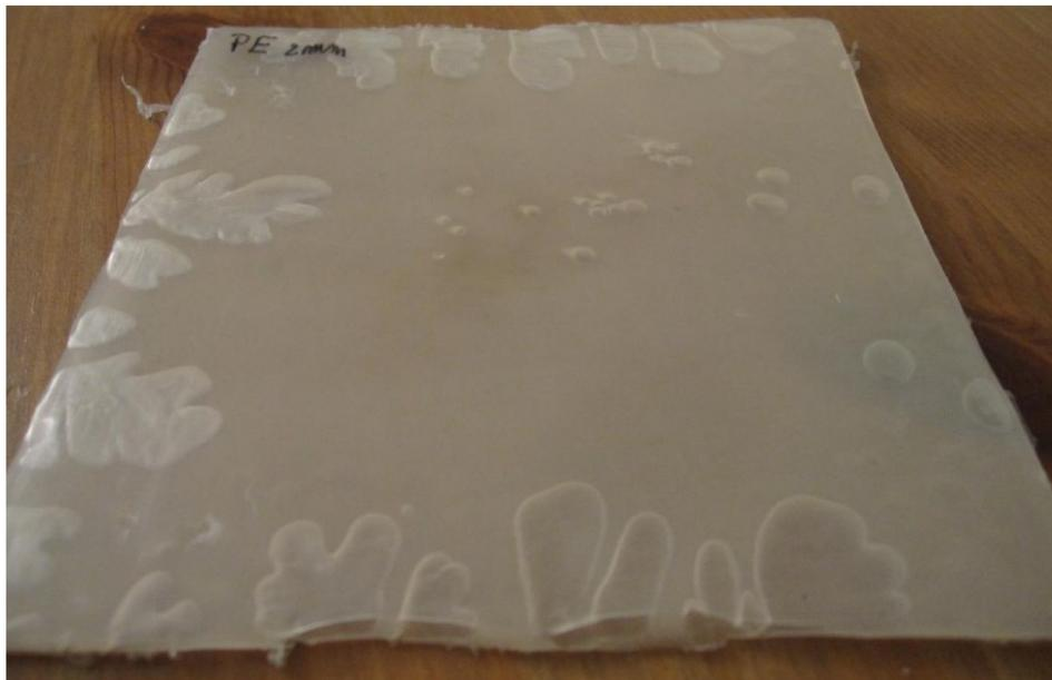
Figure B.1 : Plaque de LLDPE obtenue au premier essai
