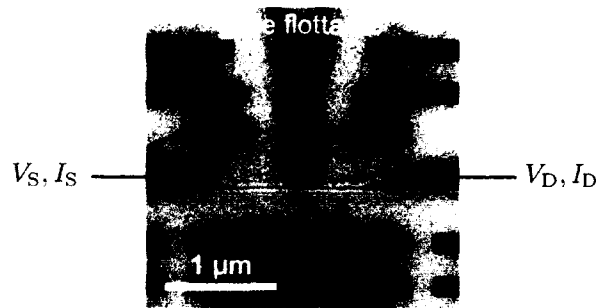
Figure 4.6. Schéma expérimental de la mesure de nanofils. Les canaux sont notés selon la convention ( VAR_{source} , VAR_{mesure} ).
