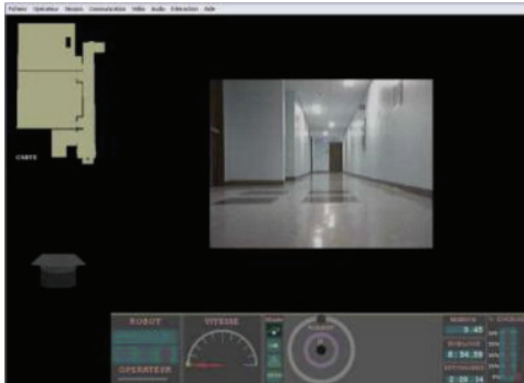
Figure 2.2 Interface à modalité vidéo centrée 2D (VC2D) [Labonté, 2008]
